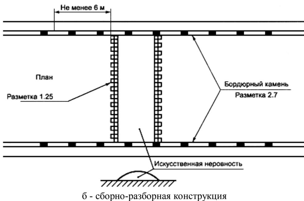
Рисунок 4 - Пример нанесения разметки 1.25 и 2.7 при устройстве ИН
